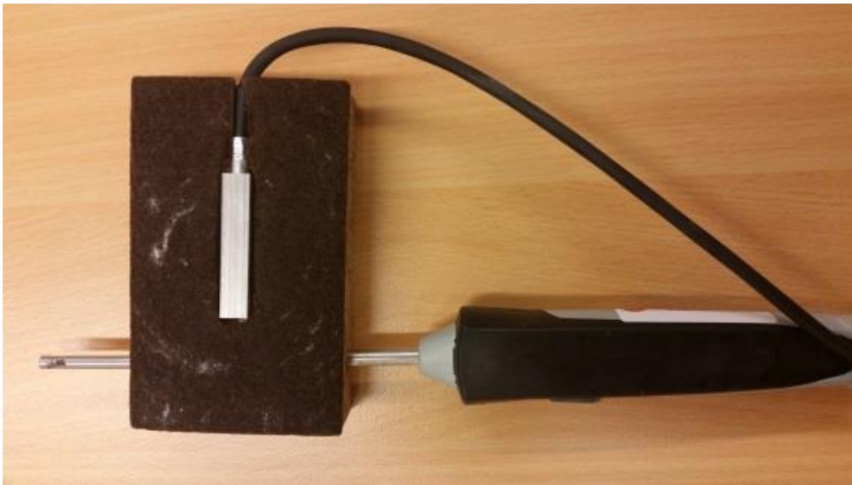
Foto A7: Houder met meetsensoren voor meting plafondtemperatuur en luchttemperatuur 1 cm onder het plafond
