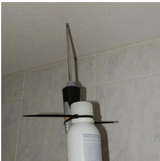
Foto 1.3 Meting van de temperatuur net onder het plafond (links) en de plafondtemperatuur (sensor tegen plafond geklemd met een kunststofstrip) (rechts)
