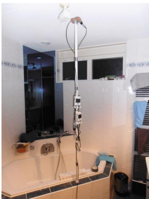
Foto 1.5 Plaatsing van de meetboom.
