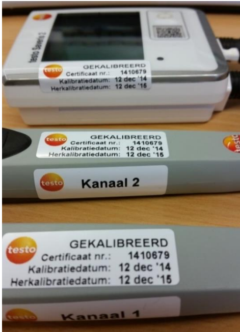
Foto A1: Datalogger en sensoren zijn samen gekalibreerd.
