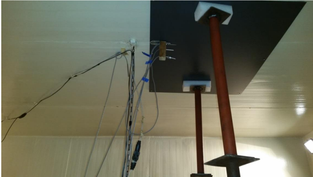
Foto 2.3 Houten plaat bij het plafond met de temperatuursensoren
