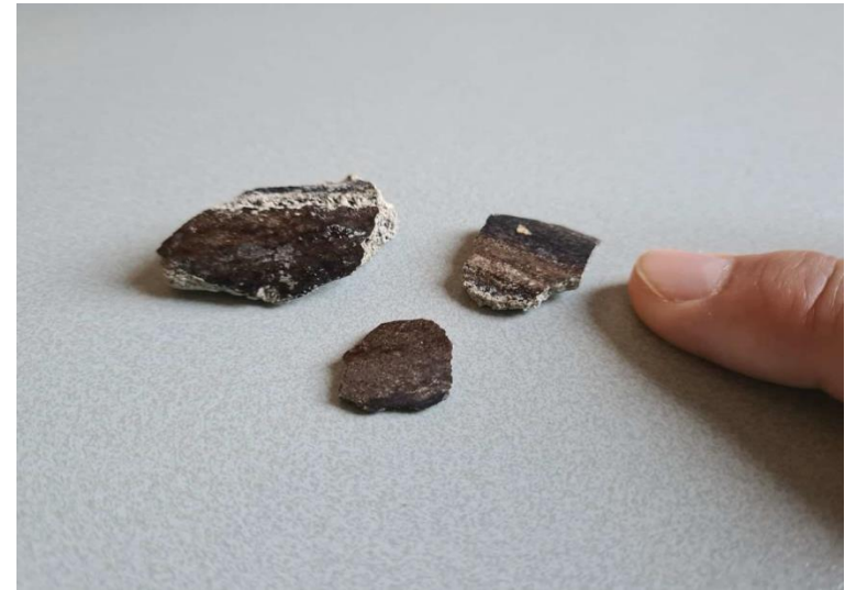
Figuur 4.66 Foto met een aantal aangetroffen afzettingen, gladde kant, zat direct tegen buis aan
