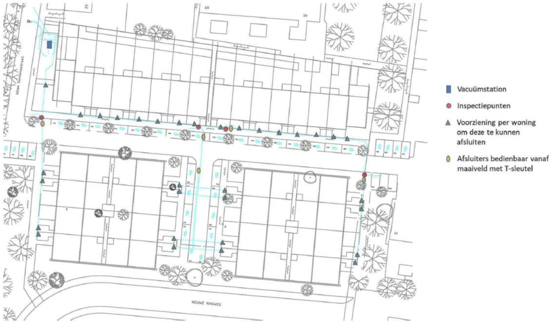
Figuur 2.1 Overzichtstekening vacuümriolering incl. aangebrachte voorzieningen
