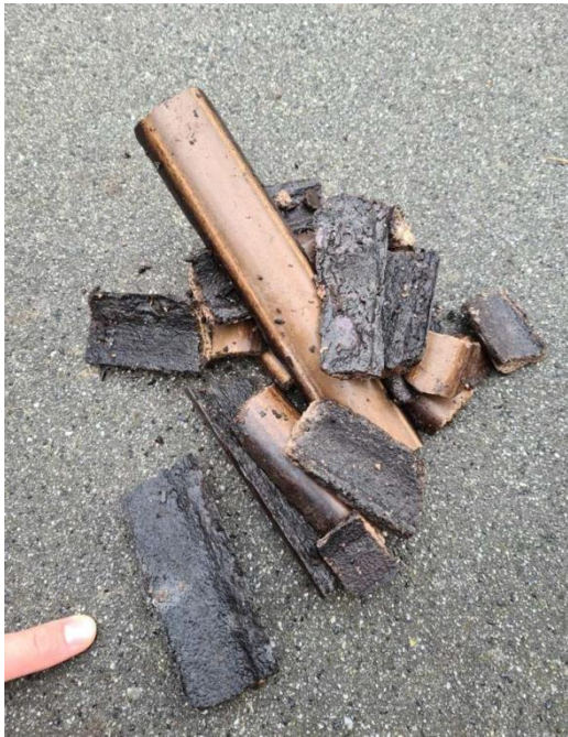
Figuur 2.1 Foto van de urinesteen afzettingen uit leidingdeel zorgcomplex
