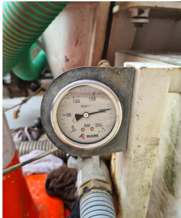
Figuur 2.3 Foto van bedrijfsdruk tijdens hogedrukreiniging
