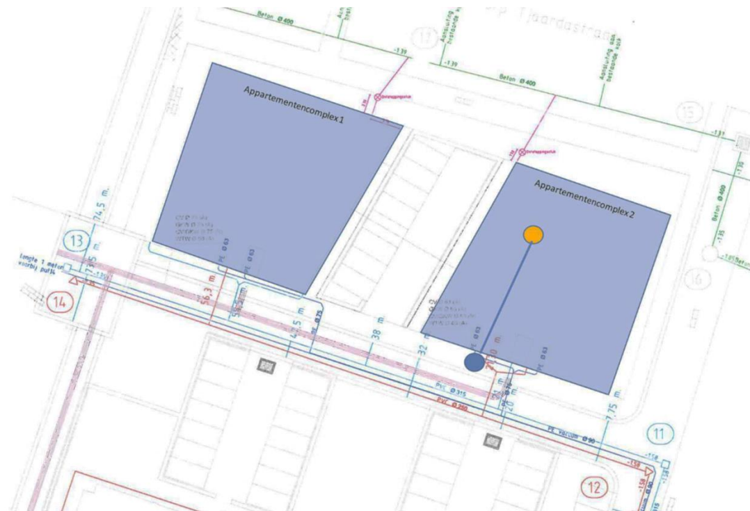
Figuur 2.1 Testopstelling t.b.v. chemische reiniging met Cee-Bee. Oranje bolletje weergeeft bij benadering locatie waar Cee-Bee wordt gedoseerd. Het blauwe bolletje weergeeft het inspectiepunt t.b.v. camera-inspectie waarbij de leiding (blauwe lijn) kan worden geïnspecteerd
