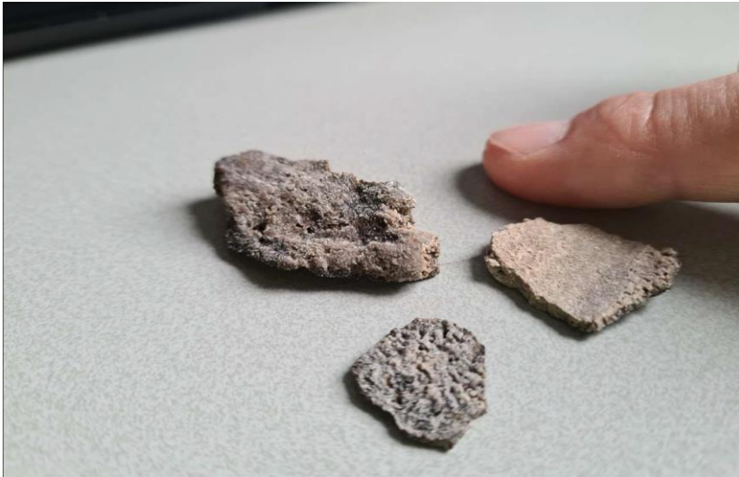
Figuur 4.65 Foto met een aantal aangetroffen afzettingen, ruwe kant
