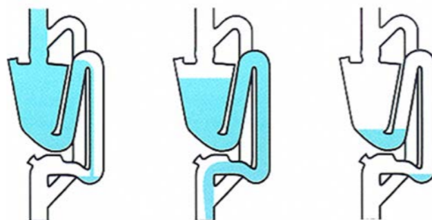
Figuur 48: Werking van de booster door vacuüm in de verticale buis wordt het reservoir leeg getrokken.
