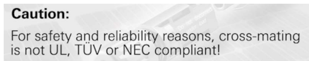
Figuur 8 Waarschuwing in de montagevideo van Stäubli ten aanzien van combineren van verschillende merken connectoren.
